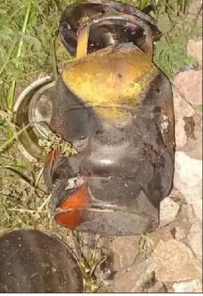
■ टैंक किनारे पड़े पत्थरों से टकराकर सिलेंडर पिचक गया। बड़ा छेद भी हो गया था।
